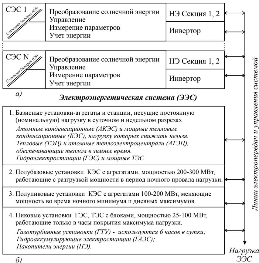
**Рис. 6. Примерный состав оборудования гибридной электроэнергетической системы**
