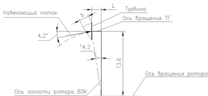
Рис. 3. Схема косого обдува при угле между набегающим потоком и осью вращения турбины
