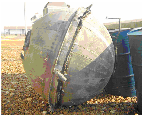
Рис. 3. Фрагмент кислородного бака третьей ступени ракеты «Ариан», вошедшей в плотные слои атмосферы над территорией Бразилии в августе 2006 года
